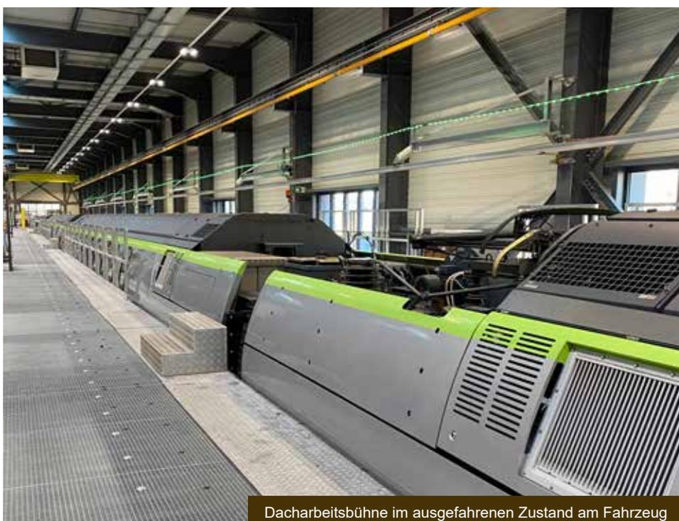
Dacharbeitsbühne im ausgefahrenen Zustand am Fahrzeug
